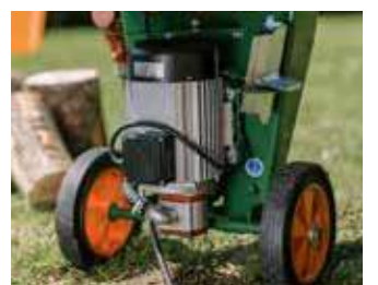
Le puissant moteur électrique 5,5 kW en détails On peut également y voir le dispositif de rangement du couteau de fendage à l'arrière.
