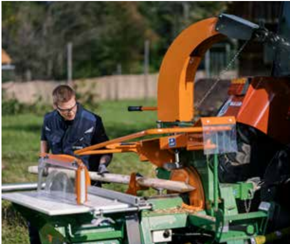
Le SchälProfi vous permet d'écorcer et d'appointer les grumes. Grâce au montage de scie circulaire, vous pouvez si nécessaire les couper au milieu.
