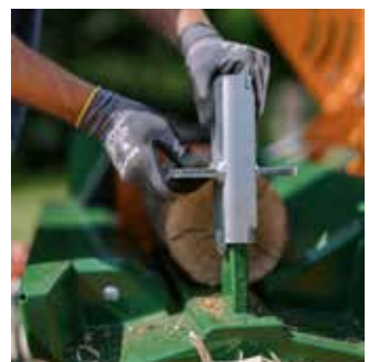
Oscar : Le coin croisé retournable 4 éclats proposé en option peut être utilisé des deux côtés pour les différents diamètres de bois.
