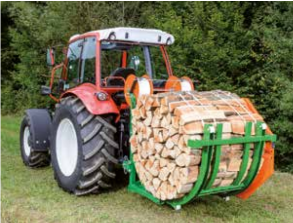
Le fagoteuse de bûches comme complément idéal à tous les : fendeurs à bois : tend des bois courts et de un mètre avec le ruban composite (illustration voir référence M7200, F0003532 et F0002557).
