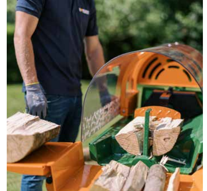
Du bois de chauffage en toute simplicité – avec le couteau 2 éclats en série, avec plateau supplémentaire en option (F0005685).
