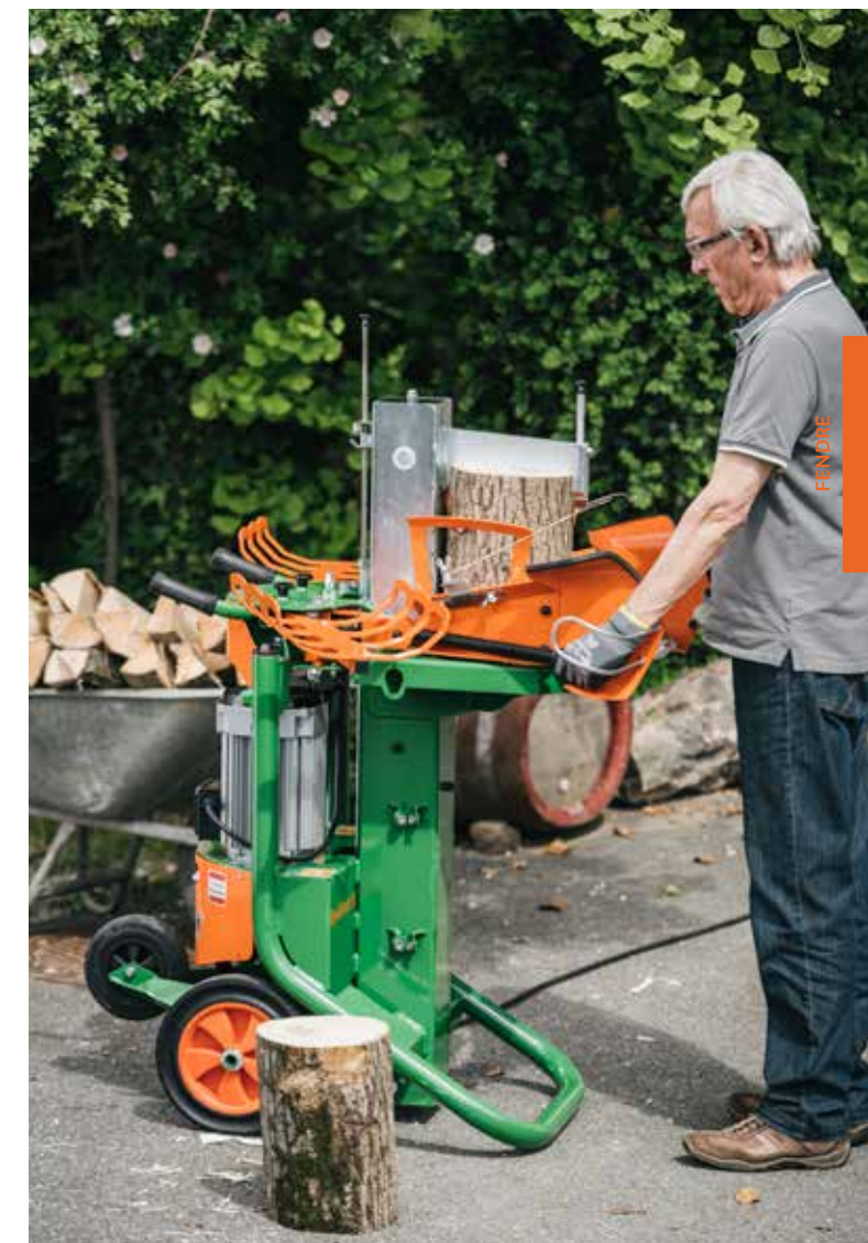
La SpaltAxt 10 possède un couteau de fendage de 26 cm de long avec lequel du bois ayant un grand diamètre (jusqu'à 40 cm) peut être traité.
