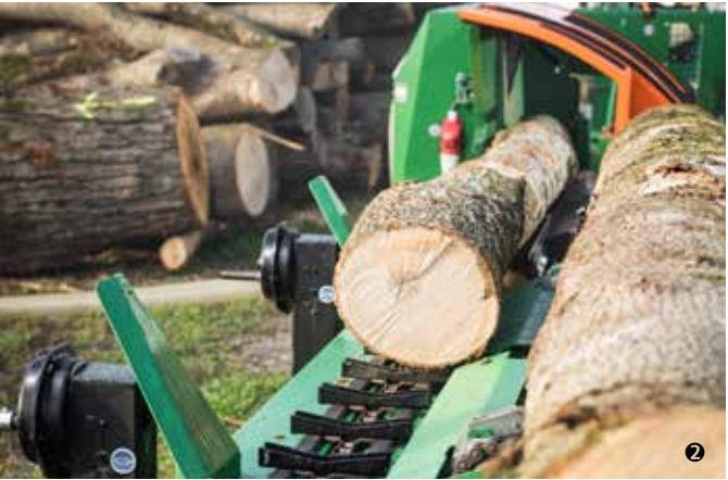
Chargement continu au moyen du système de transport des grumes, composé 1 d'un convoyeur transversal et 2 d'un convoyeur longitudinal.
