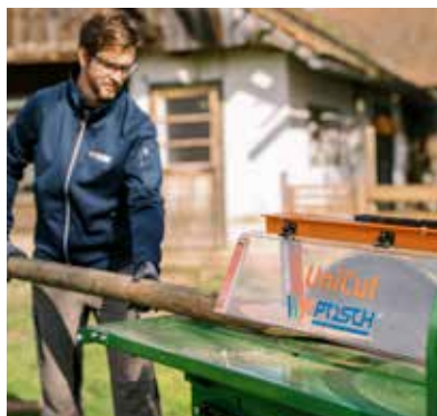
De série : kit de rééquipement pour appointer et séparer les troncs/rondins. Article n° F0004619
